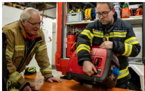
Im KLF wurde ein kompakter Stromerzeuger mit 2 KVa eingebaut.
