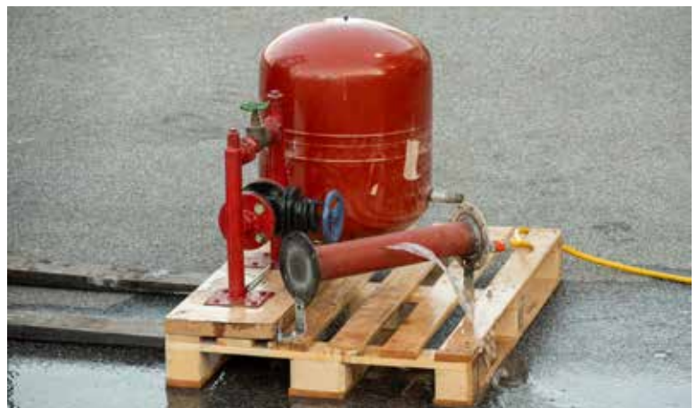
Von Josef „Ferdl“ Riedl wurde eine Übungsarmatur angefertigt. Damit können wir das Abdichten von auslaufenden Flüssigkeiten besser üben.
