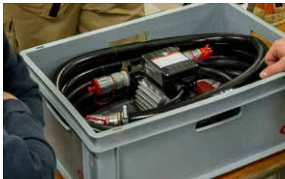
Eine neue Dieselumfüllpumpe wurden für den Rollcontainer Ölschaden angekauft.
